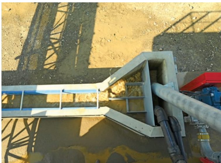
Canal Venturi, servant à mesurer un débit à partir d'une hauteur d'eau. Il collecte les eaux d'exhaure retournant au plan d'eau et mesure leur débit instantané et leur volume global. Un point de prélèvement y a également été aménagé pour caractériser les rejets (particules en suspension, chimie de l'eau).
