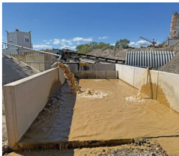
Deuxième bassin en béton, en sortie du tunnel, pour stocker les eaux recyclées du process et faire sédimenter les matériaux. Des débitmètres connectés équipent toutes les conduites d'eau et font remonter les débits instantanés et les volumes globaux au superviseur.
