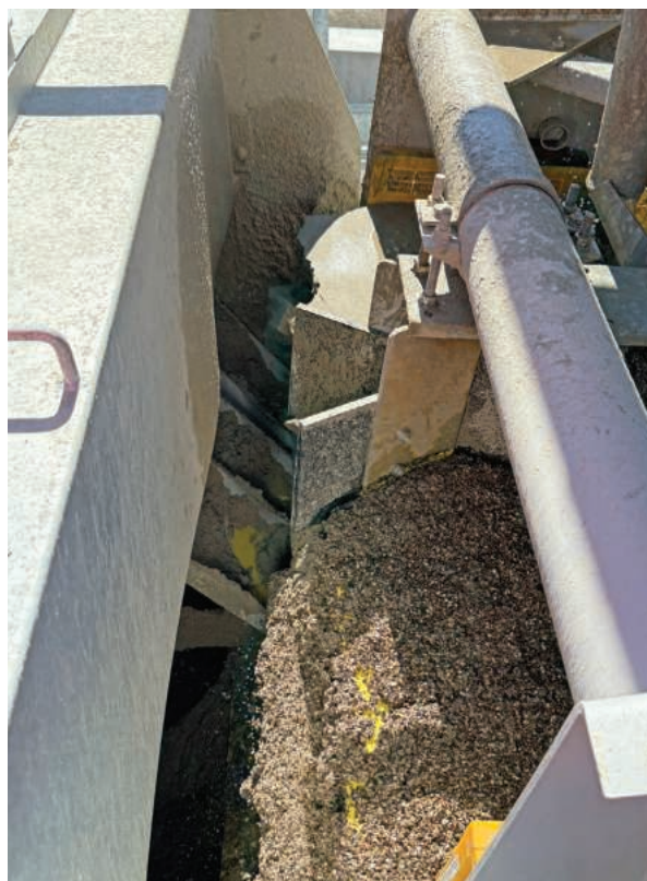
Recomposition des sables 1 mm – 4 mm et 15 – 800 microns, valorisés par un module MS indépendant. Cette étape n'a pas été automatisée par l'exploitant, volontairement, afin de conserver une expertise visuelle chez les opérateurs.
