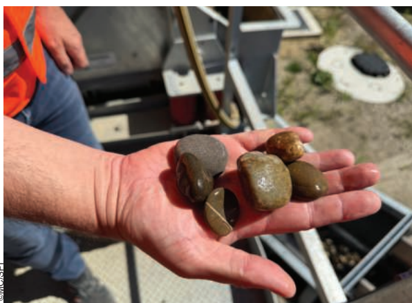
Ces silico-calcaires exploités à Benfeld sont abrasifs donc durs. Ils se destinent à des ouvrages techniques.
