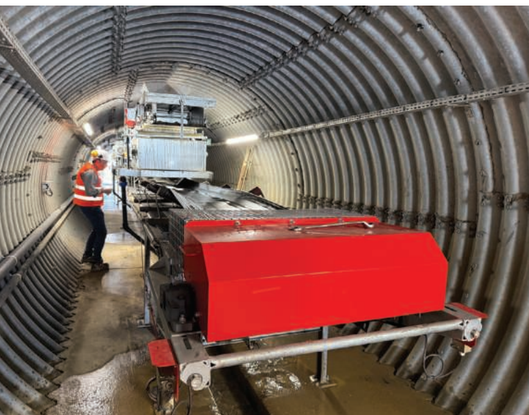
Tunnel de convoyage sous le stock-pile, construit avec son caniveau en pente pour récupérer toutes les eaux d'égouttage.
